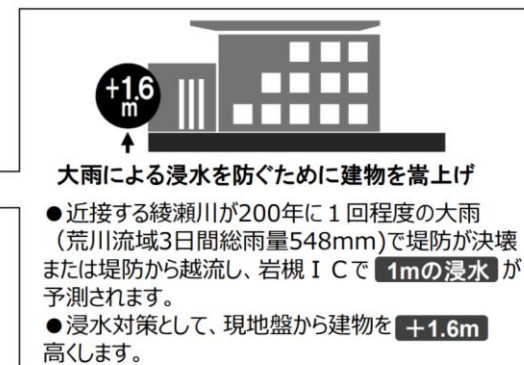
＜冠水が想定され対策を行った事例＞ 東北自動車道 岩槻IC
