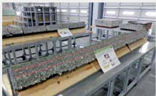
損傷舗装の実物供試体
