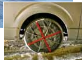
布製カバートイプタイヤチェーンを使用した立ち往生車両の移動
