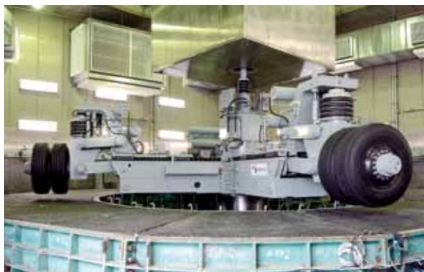
国内唯一の大型回転式舗装試験機(NEXCO総研)
