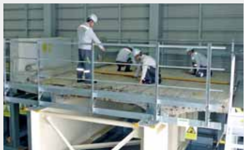
橋梁床版の実物供試体
