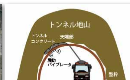
▲中流動コンクリート施工イメージ
